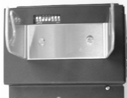
PRZEŁĄCZNIKI SW8 do SW1 (ON dół, OFF góra)
